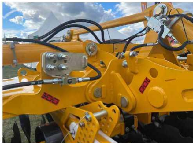
SYSTÈME DE DÉPLIAGE AVEC PROTECTION HYDRAULIQUE
