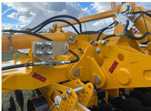
SYSTÈME DE DÉPLIAGE AVEC PROTECTION HYDRAULIQUE
