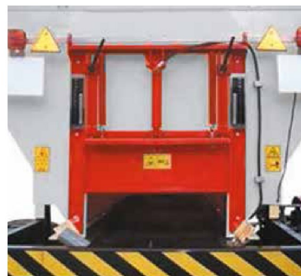
FENÊTRE LARGE DE DÉCHARGEMENT POUR LE COMPOST
